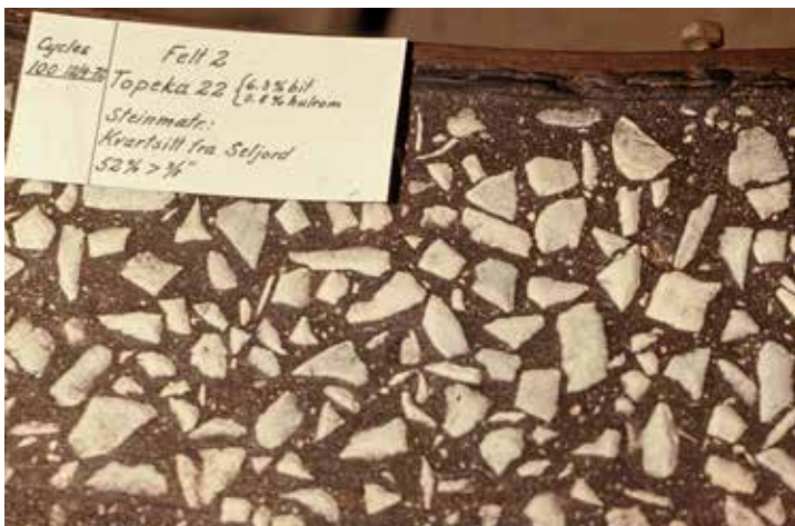
Nærbilde av asfaltdekkeprøver på ringbanen. (Foto: Torkild Thurmann-Moe)
