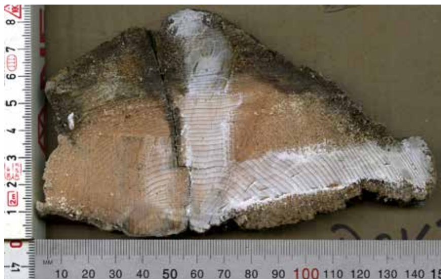
Figur 2: Tverrsnitt av prøven med de to preparerte radiene.
