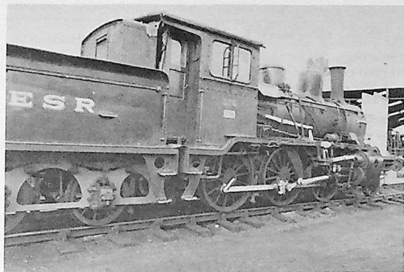
Lokomotivet med deler av kjelkleddningen fjernet for reparasjon av rustskader.
