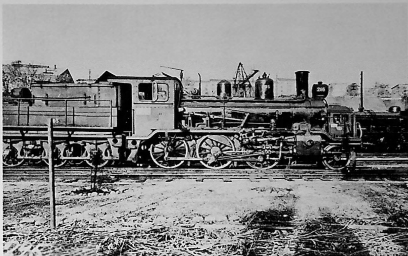
Dette bildet er tatt i Lodalen i 30-årene. Lok 295 type 21b og lok nr 1 type 45. Lok 295 har gangbrett på siden av tenderen. Dette var for at fyrbøteren også var billettør på enkelte tog.
