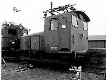
Ett za 267,elektrisk skifte lok beregnet for skifting uten lokførere
