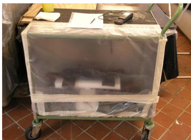
Fig. 5 Tørringskammer med termohygrometer
