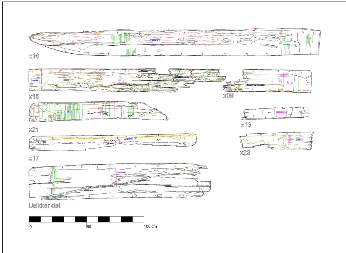
Figur 143. Alle store deler av hubord i funnet. Det nederste bordet (usikker del) ble gjenfunnet i karet uten merketag på. Ut fra foto er det mulig å relokalisere det til funnstedet, og dette sammen med datering og andre faktorer gjør at delen tolkes som del av funnet. Tegningene er i 3D og man ser derfor alle sidene av delene.
