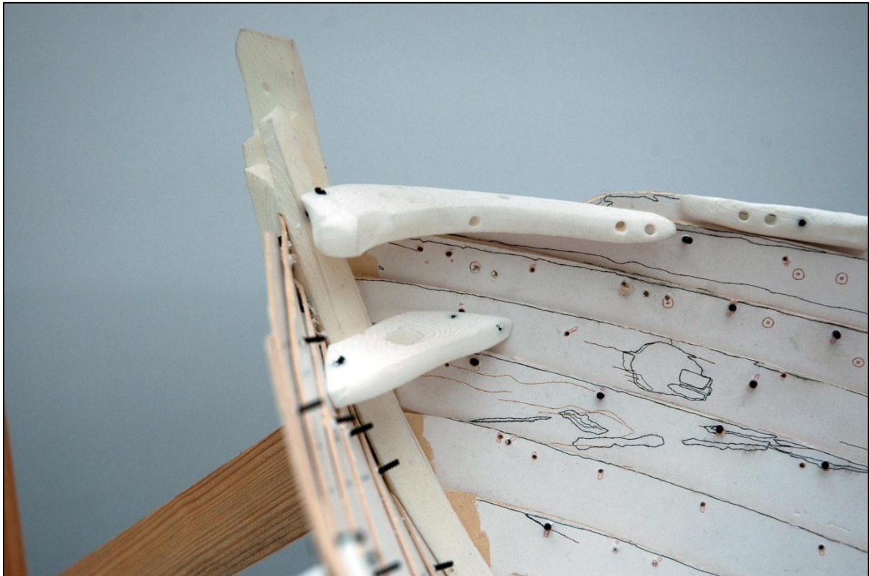
Figur 58. Plassering av stevknene inn mot øvre del av forstevn. Masten har vært støttet mot dette ved halvsirkelformet spor. Selve mastesporet med firkantet hull ligger under og er festet til 7. bord.
