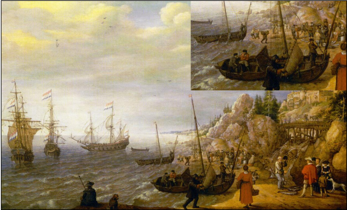
Figur 54. To båter omtalt som pinket i et Skandinavisk miljø (Gaschke (red.) 2008:184-185). Båtene har to master, med hovedmast framom midten av båten og en skråstilt formast. Seilet ser ut som et råseil, men dette er uklart. Maleri av Adam Willarts datert 1625.
