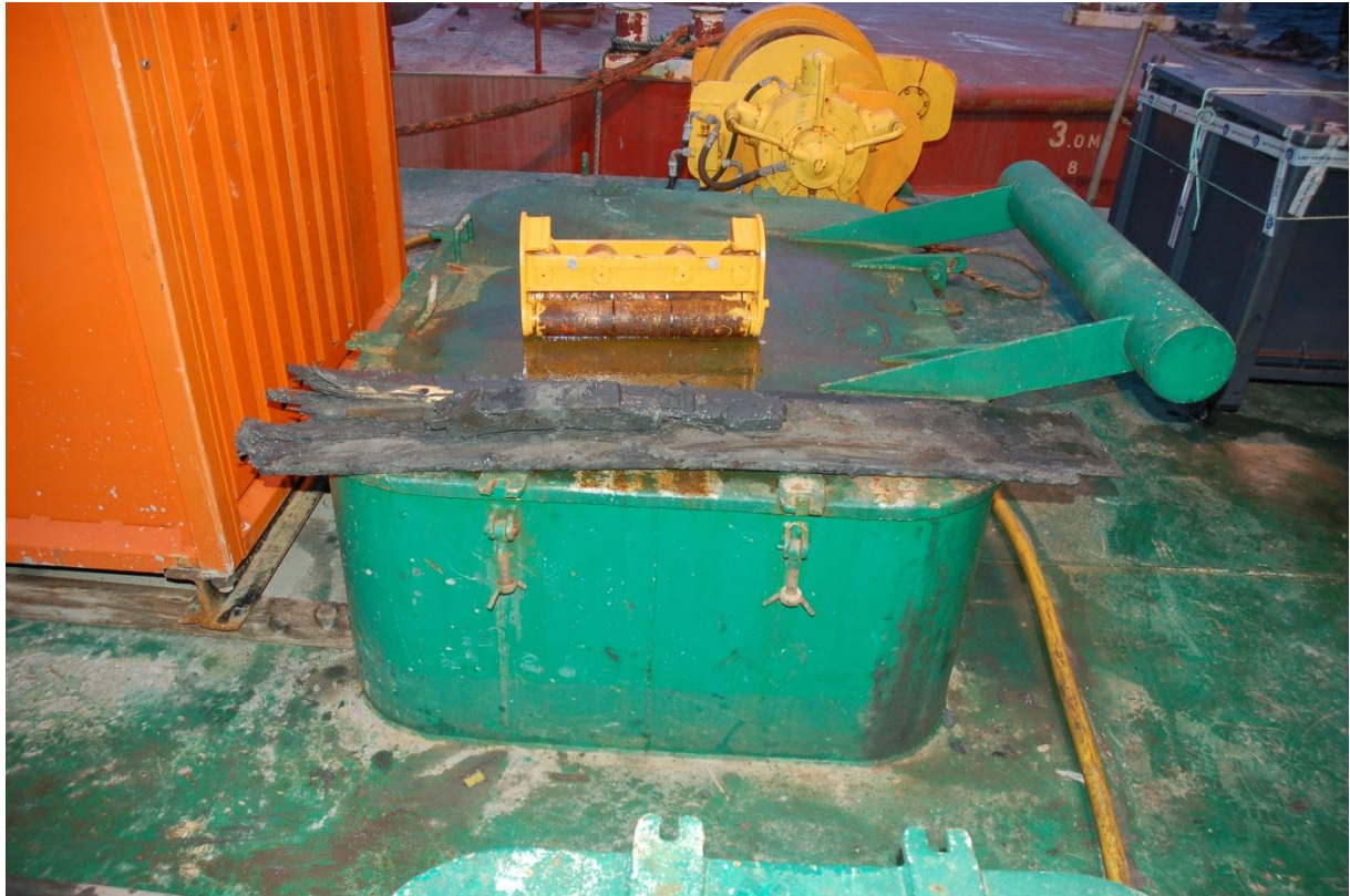
Figur 145. Funn av hudbord (x19) og fragment av band fra båten NSM 03010026. Ene enden er intakt, mens bruddenden skyldes møtet med mudringsgrabben.
