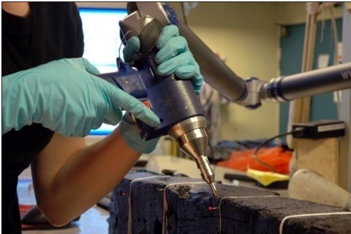
Figur 6. FARO-armens målespiss med pistolgrep i bruk. Ved å taste rød eller grønn knapp mens man holder spissen stødig mot objektet, velger man hvor punktet skal settes.
