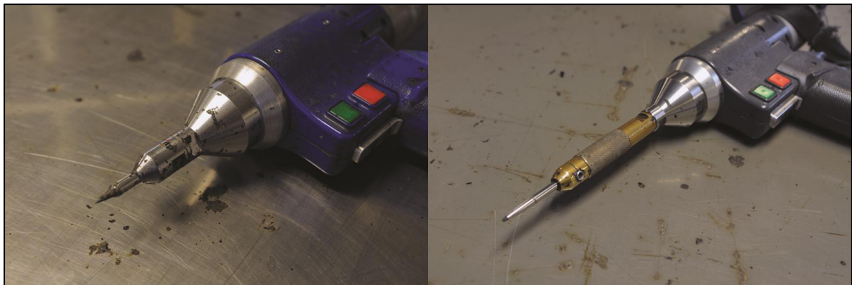
Figur 7. Målespisser. Carbide point probe (t.v.) og spesiallaget probe med myk PDA-spiss.
