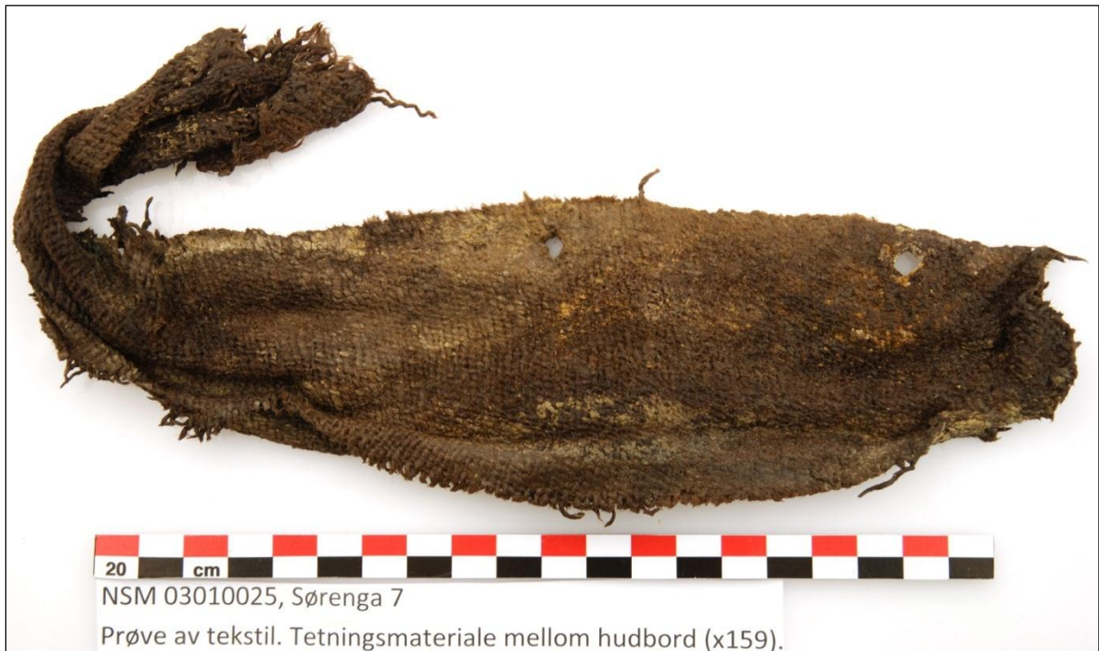
Figur 61. Fragment av tekstil på hudbord x159, 2. bordgang på babord side. Prøven ble sendt inn til analyse (x441). Tydelige hull etter spiker. Tekstilet har vært foldet og rullet. Foto: Kristina Steen/NSM.
