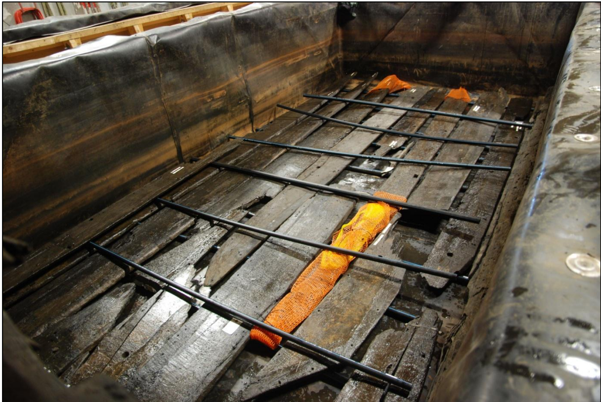
Figur 17. Sørenga 7 legges lagvis i kar før PEG-behandling. Plastrør er lagt som strø i mellom lagene med treverk og sørger for gjennomstrømning av PEG.
