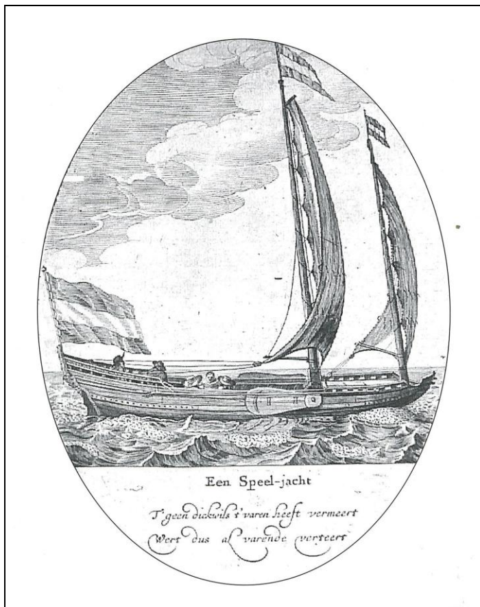
Figur 56. Tomastet hollandsk speiljakt med gaffelseil. Gjengitt i Mortensøn (1995:59), basert på stikk fra Navium Hollandicarum 1627. Eksempel på tomastet båt med hovedmasten langt framme i båten.
