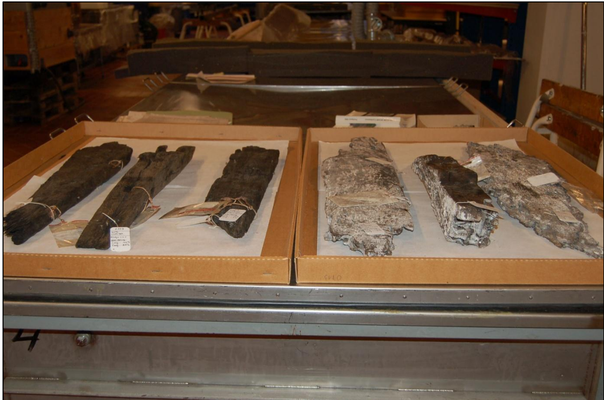
Figur 18. Båtdeler fra Sørenga 7 som har gjennomgått ulik grad av konservering. Delene t.v. er PEG-behandlet og frysetørket, mens delene t.h. er PEG-behandlet og deretter tørket sakte i kontrollert temperatur. Det er en del rest-PEG igjen på overflaten til de sistnevnte delene. Foto: Konserveringsavdelingen i Brede.
