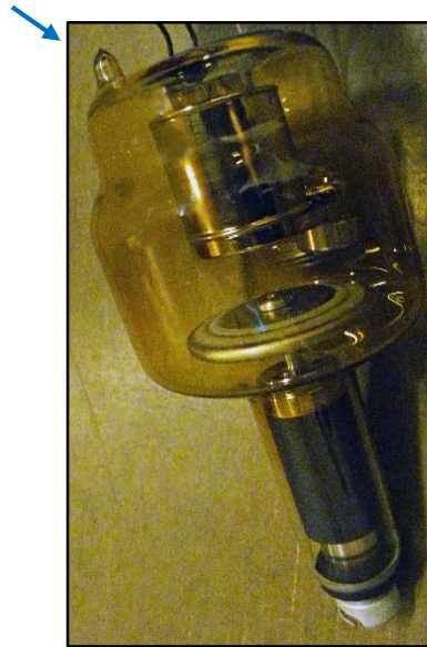
Sikkerhetsventil på rør med tallriksanod.
