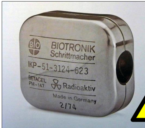
147 Promethium-pacemaker utan elektrod Ägare/foto: Berliner Medizinhistorisches Museum der Charité Tillverkning: Biotronik, Berlin, Tyskland, 1974 Innehåll: Promethium/Samarium, elektronik, epoxi, metall Mått: 30 x 51 x 43 mm
