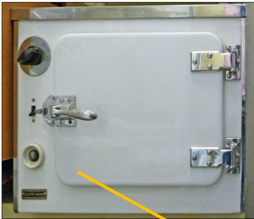
Värmeskåp, 1950-talet, Elektro-Helios, Sverige Mått: 350 x 470 x 325 mm Samling Sahlgrenska museet SM
