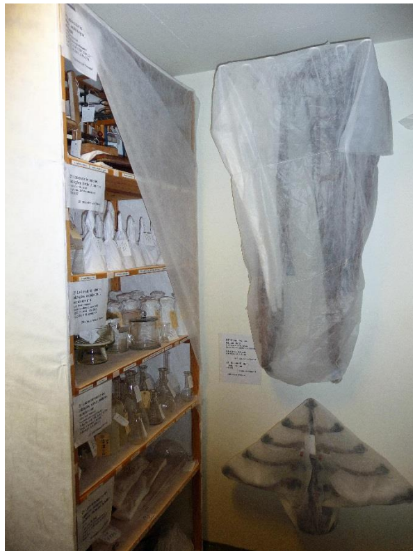
Tyvek sikret med aluminiumtape mot baksiden/siden av åpne metallplatehyller
