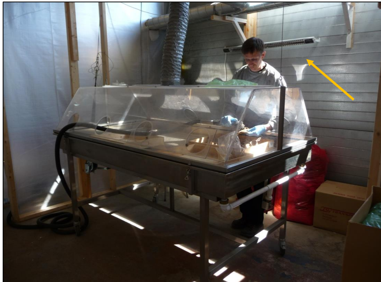
Sanering av bein i et spesialdesignet sugebord med lavtrykk i kammeret. Merk! Bruk kun direkte varmekilder som infrarøde varmelamper, ikke varmeapparater med ventilator virvlende rundt støv og sporer
