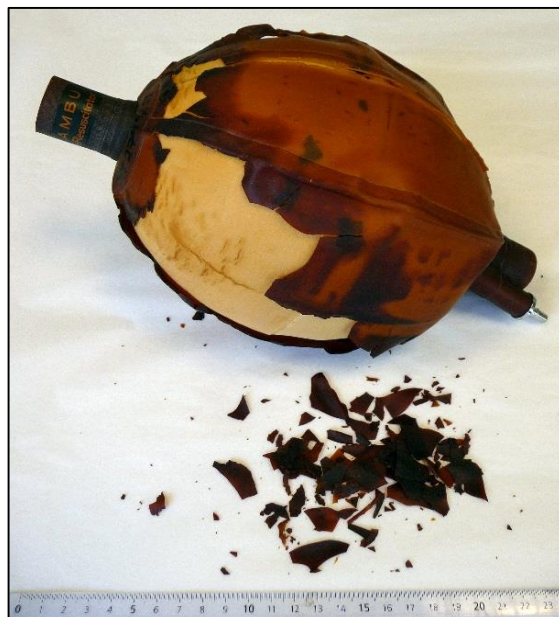
Del til respirator av gummi og polyuretan med oppløsningsproblem
