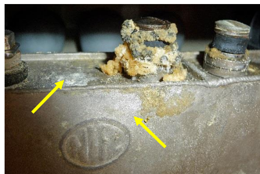
Frätande omvandlingsprodukter på blybatteri
