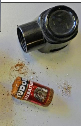
Ögondiagnostikinstrument, handlampa 1960-talet Samling S.M. Korrosionsskada p g av kvarglömda brunstensbatterier med salmiakk som elektrolytt
