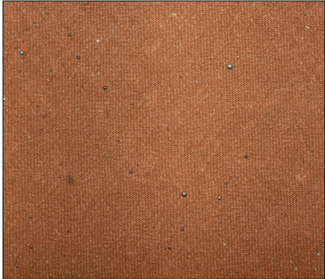
Dropper av kvikksølv i bunn av oppbevaringsboks til kvikksølvmanometer
