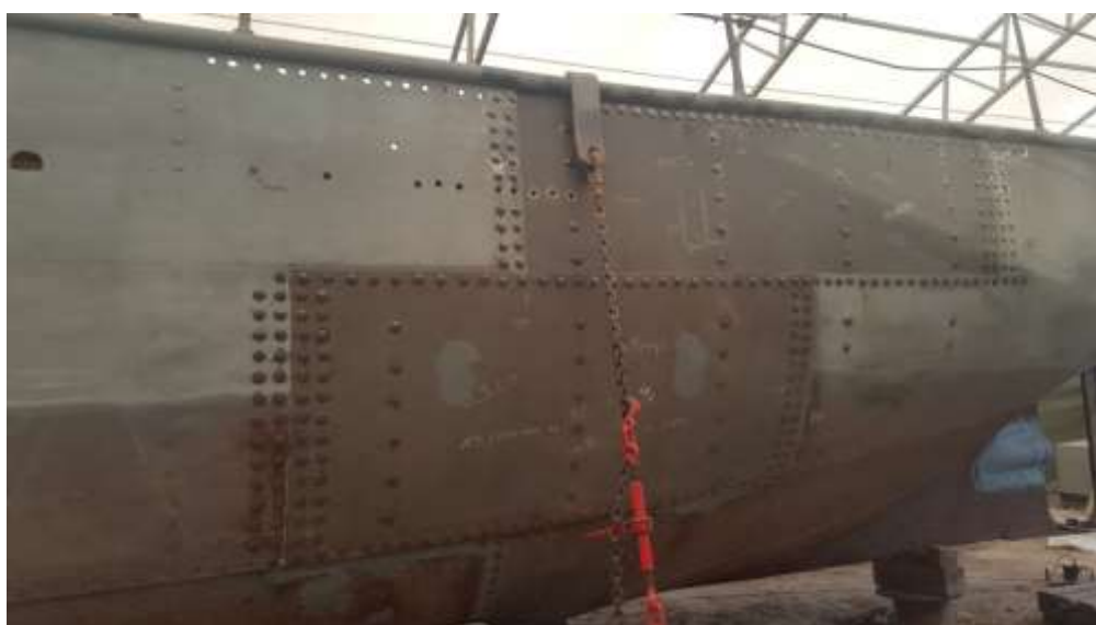
F-gang babord plate, fenderlist og bindevinkel ferdig montert.
