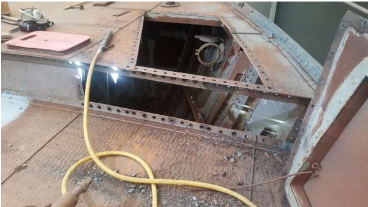
Svinerygg SB og BB, rep av bindevinkler v fenderlist og dekkplate ved lukekarmen
