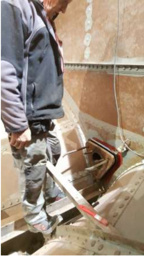
Ny foring og innfesting av propellhylse
