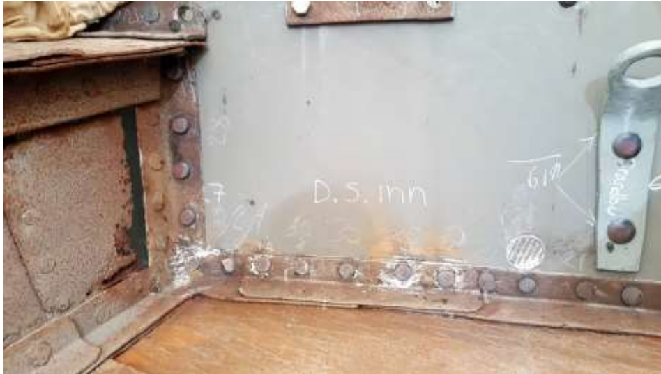
Svinerygg SB og BB, rep av bindevinkler v fenderlist og dekkplate ved lukekarmen
