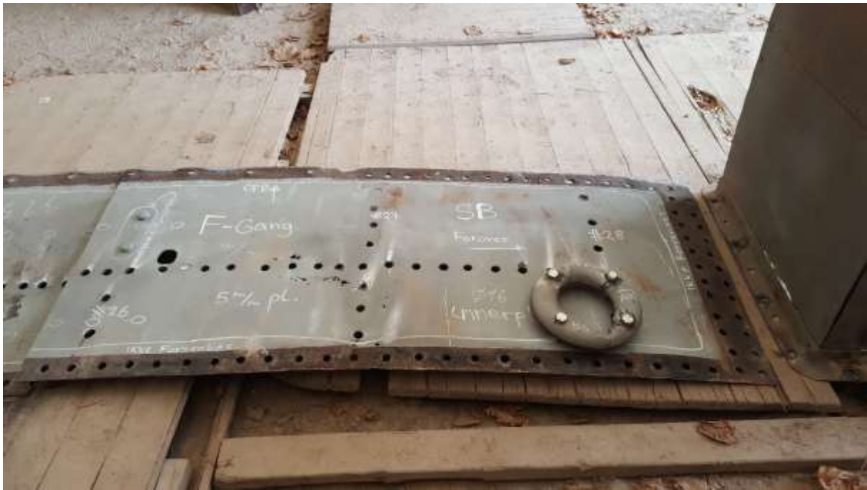
Ankerklyss babord demontert for reparasjon og kopiering til styrbord.
