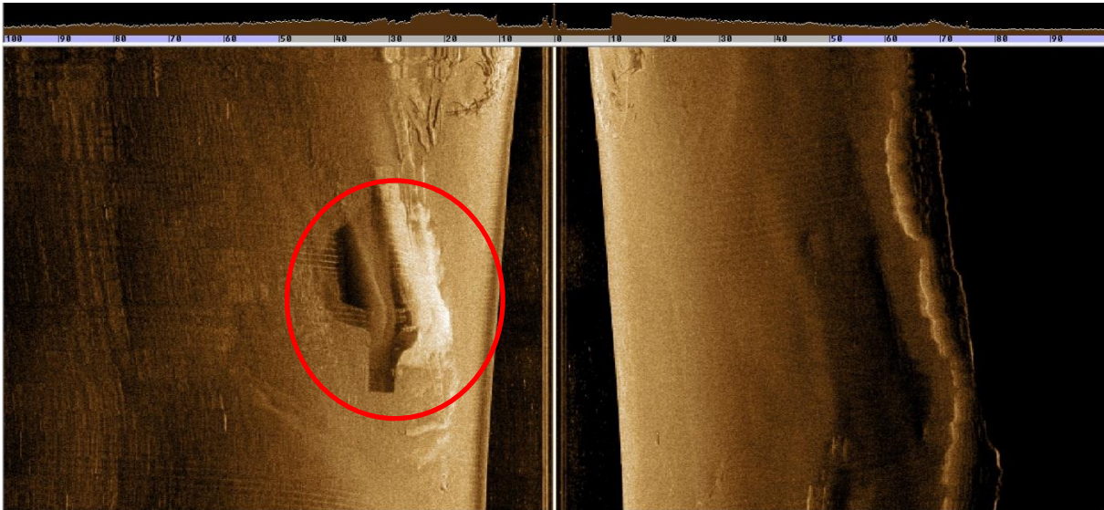
Figur 7 Sonogram. Inntak til vannverket rammet inn i rødt. Elvebredden synes til høyre på ca 60-70 meter. Vannsøylen er det mørke partiet under sonarfisken.
