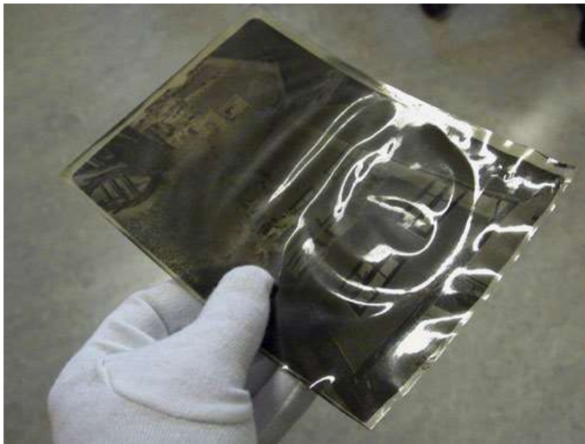
Typisk nedbrytningstegn: deformasjon av cellulosenitrat film. Foto: Jens Gold
