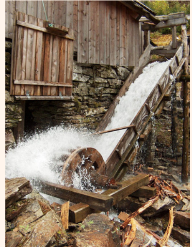
Vannhjul til oppgangssag fra Kvam. Foto: Svein Høikstad
